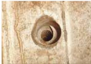
Surface du béton après le dévissage
