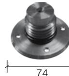
Disque de fixation M 36 en acier, clouable, dévissable avec embout carré 12/12 (sur clé M 24), ø disque 74 mm
